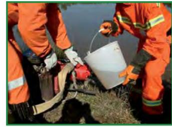
In caso di uso di pompe centrifughe controllare sempre che il corpo pompa sia completamente riempito d'acqua
