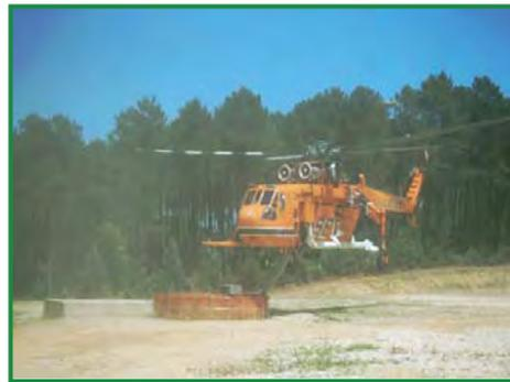
Le vasche grandi, attualmente usate in Toscana, hanno capacità di 25.000 litri ma una profondità insufficiente a permettere il pescaggio con il mezzo aereo regionale provvisto di benna. Per tale motivo
