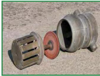
In presenza di una valvola di fondo controllarne il corretto funzionamento, verificandone la regolare chiusura e apertura
