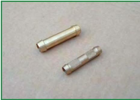
E' preferibile l'utilizzo di un giunto fisso tipo quello riportato nella foto, rispetto a un giunto a vite perché la rottura viene riparata più rapidamente e, una volta montato, è meno ingombrante in fase di riavvolgimento.
