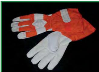
**Guanti.** Solitamente in pelle con parti di tessuto ignifugo. Devono proteggere da lesioni o abrasioni e devono impedire il contatto di materiale incandescente con la cute. Devono avere polsini lunghi per ricoprire parte della manica della tuta.
