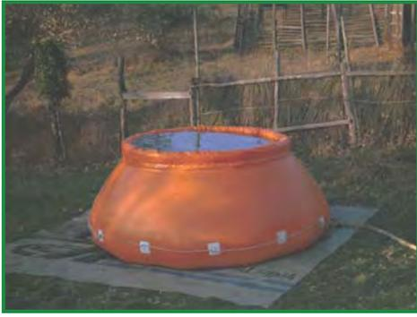
Per quanto riguarda le vasche autoportanti, queste sono costituite solo dal telo che presenta forma troncoconica con alla sommità un anello molto leggero che funziona da galleggiante e che mantiene alti i bordi della vasca. Hanno bisogno di particolare attenzione in fase di montaggio, perché eventuali pieghe sul fondo possono compromettere il completo riempimento; sono utilizzate specialmente come serbatoi di compensazione nelle linee di manichette.
